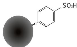
**WondaSep MCX**是以苯乙烯-二乙烯基苯和亲水性基团共聚物为基体，导入强酸性官能团，同时具有反相和强阳离子交换作用。适合碱性化合物的富集与净化，适用于兽药残留、三聚氰胺、碱性农残等样品前处理。
