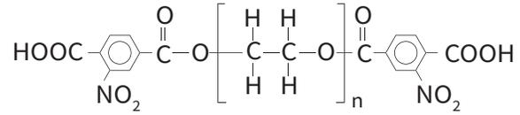
WondaCap FFAP是硝基对苯二甲酸改性的聚乙二醇强极性毛细管柱。并且在进行挥发性脂肪酸项目分析时，进样前无需进行衍生化处理。
