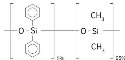
WondaCap 5是键合5%苯基-95%甲基聚硅氧烷的弱极性毛细管柱。适用于农药残留、挥发性有机物等分析。
