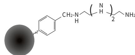
**WondaSep WAX**是以苯乙烯-二乙烯基苯和亲水性基团共聚物为基体，导入弱碱性官能团，同时具有反相和弱阴离子交换作用。适合强酸性化合物的富集与净化。相当于市面上的WAX、PWAX等小柱。
