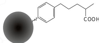
**WondaSep WCX**是以苯乙烯-二乙烯基苯和亲水性基团共聚物为基体，导入弱酸性官能团，同时具有反相和弱阳离子交换作用。适合碱性化合物的富集与净化。
