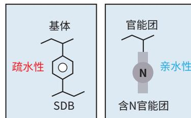
**WondaSep HLB**是亲水亲脂共平衡型固相萃取小柱，填料表面同时具有亲水性和亲脂性基团。应用广泛，对非极性到极性化合物均有较好的保留作用。
