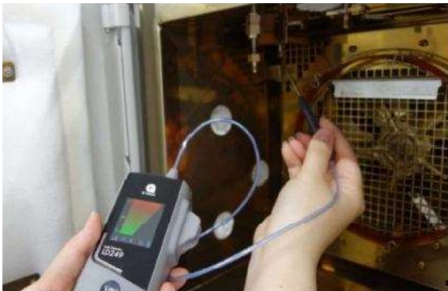
不会造成污染风险，可用于精密测量仪器检漏
