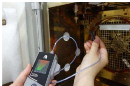
不会造成污染风险，可用于精密测量仪器检漏
